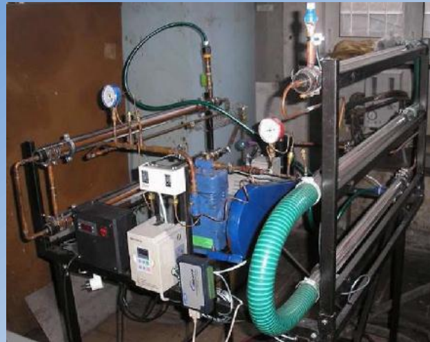
Układ chłodniczy z napędem inwerterowym (grudzień 2010)
