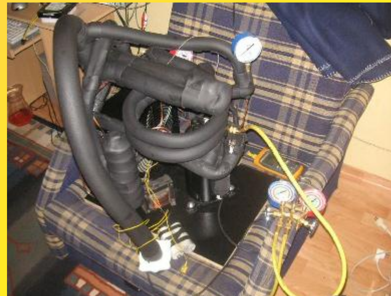
Urządzenie autokaskadowe zdolne schłodzić procesor do temperatury -65^{\circ}\text{C}
