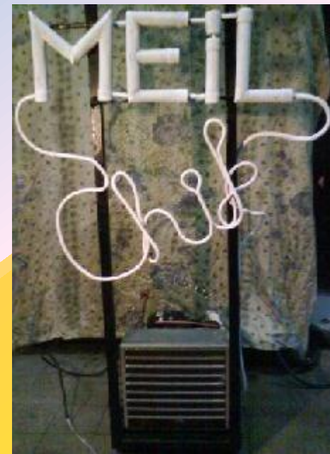
Układ chłodniczy z parownikiem w kształcie MEiL ChiK (styczeń 2011)
